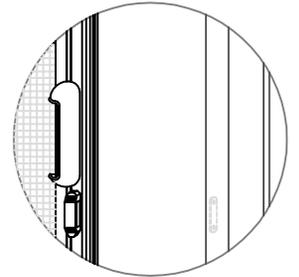
ATTACH THE MAGNET TO THE SIDE OF THE SCREENS PULL BAR, AND THE MAGNET PLATE TO THE INSIDE OF THE DOOR JAMB.
